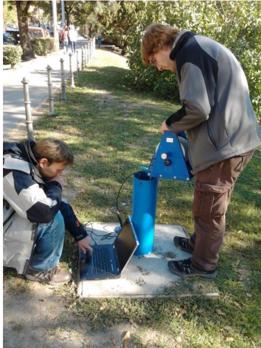
8. ábra Vízszintmérés mérőszalaggal, adatnyerés a DATAQUA memóriájából
