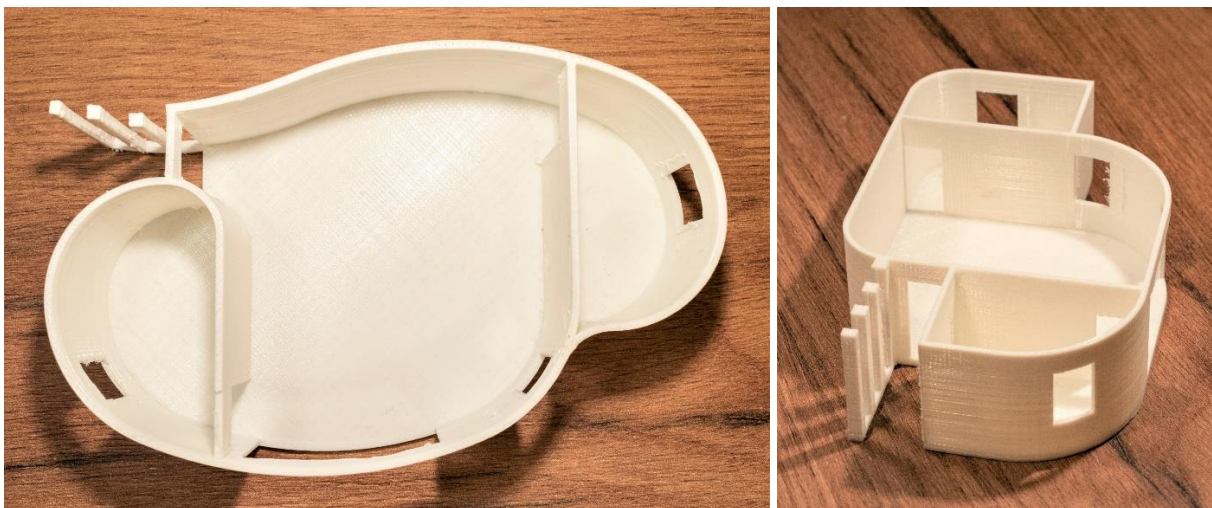
9. ábra: Íves és vegyes külső falazatú 3D nyomtatott modellek (saját fotó)
