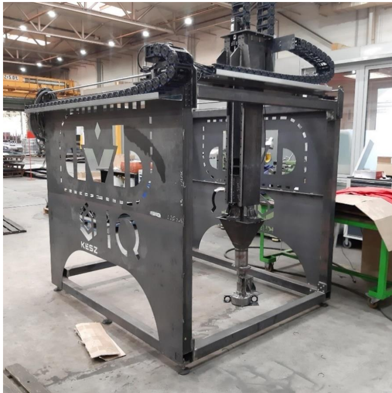
7.ábra: Az első magyar fejlesztésű 3D beton nyomtató (Fotó: DVB Kft.)
